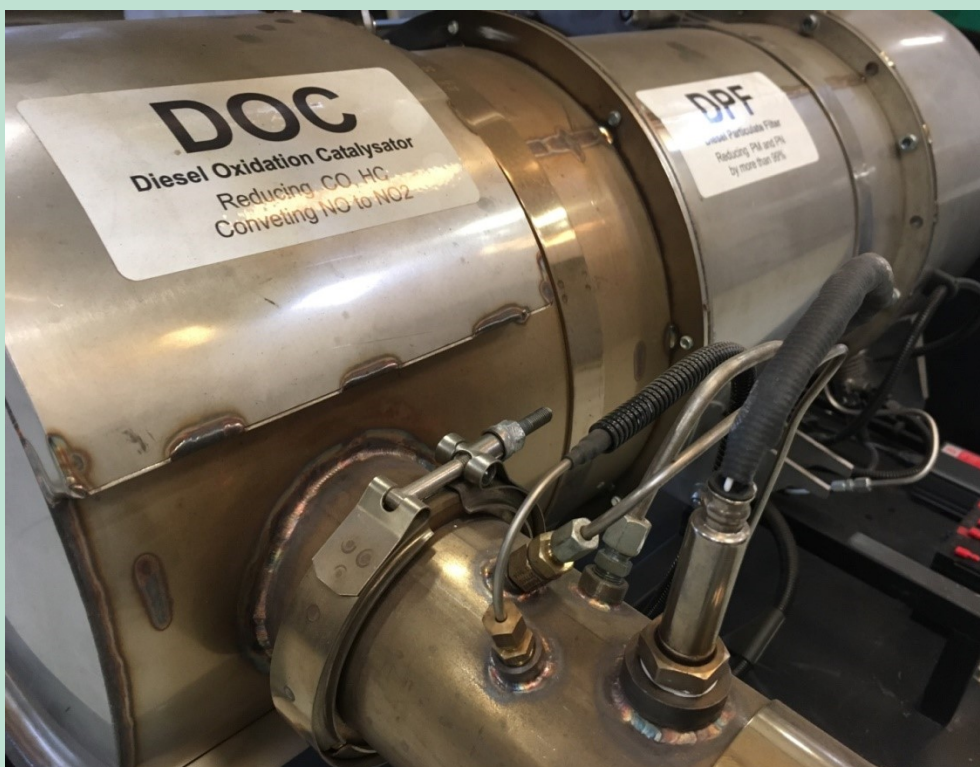
FIGUR 15. Indløbsdel på Purefi emissionsudstyr
